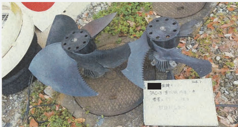
〈写真〉破損したプロペラファン
