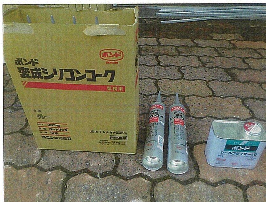
写真区分: シーリング工事 工種: 材料写真 写真タイトル: 変成シリコン 材料検収
